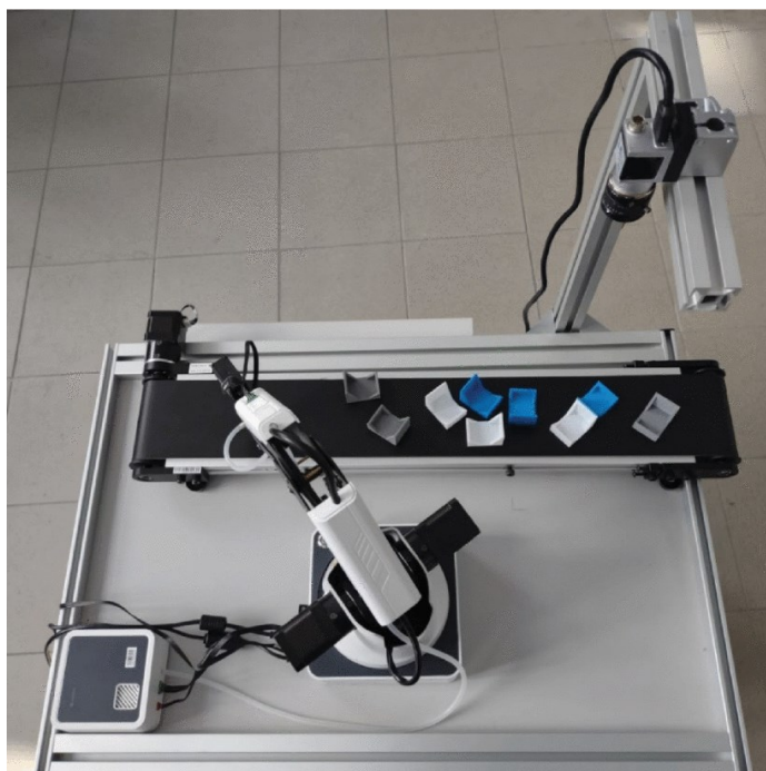
Obr. 10 Robotické stanoviště pro sběr dat. Zájmové objekty jsou rozptýleny na dopravním pásu. Pro sběr vizuálních dat se používá průmyslová kamera umístěná nad scénou. V hliníkovém profilu v blízkosti kamery je umístěno liniové LED světlo.
