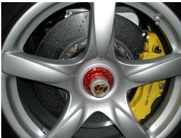
Brzdové destičky z karbonové keramiky na Porsche Carrera GT's
