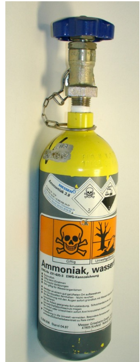
Amoniak je skladován a transportován ve zkapalněném stavu
