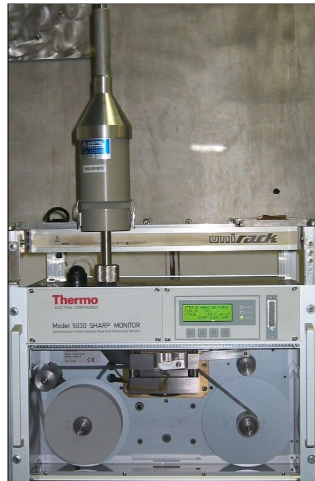
přístroj na měření polévatého prachu, kombinovaný nefelometr pro monitor PM 2,5 částic
