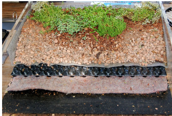
řez konstrukční skladbou zelené střechy
