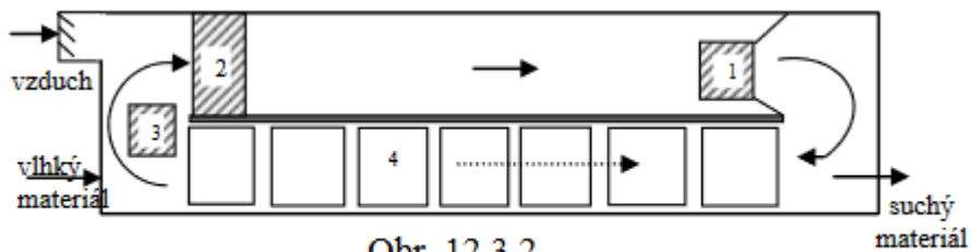
Tunelová sušárna v protiproudém uspořádání
